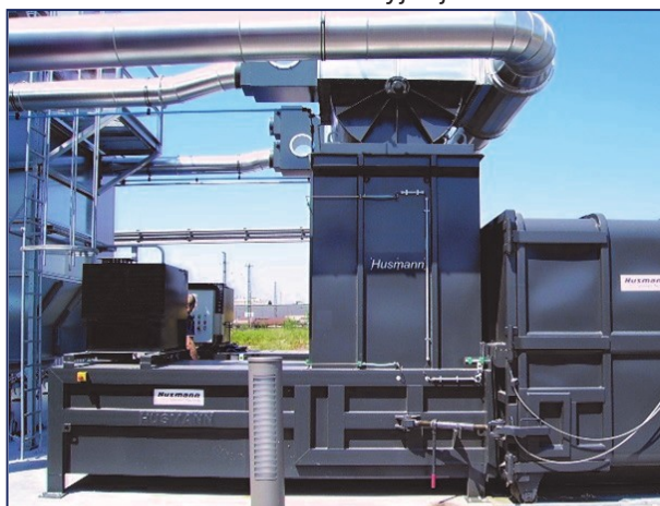
• MP 1300 z zasypem pod separatorem powietrznym
