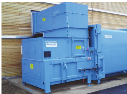
• ST-SEL z zasypem łączącym ze ścianą budynku
